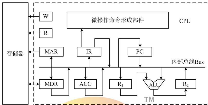
(1) 假设要求在取指周期由 ALU 完成  $(PC) + 1 \rightarrow PC$  的操作 (即 ALU 可以对它的一个源操作数完成加 1 的运算)。要求以最少的节拍写出取指周期全部微操作命令及节拍安排。(5 分)
